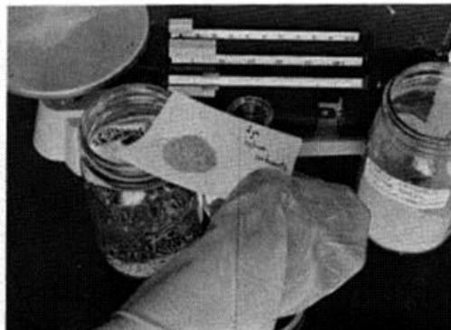
Dois gramas de concha de ostra em pó (carbonato de cálcio) são adicionados
